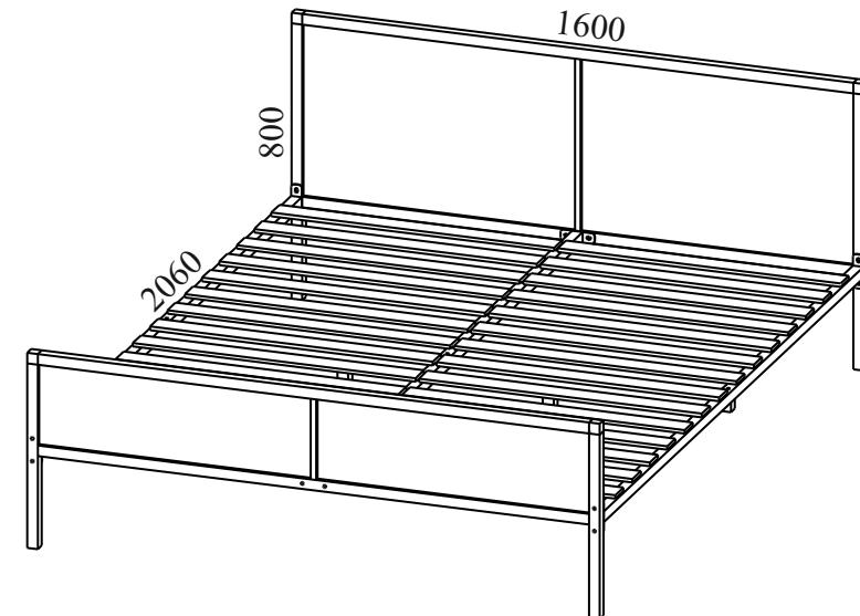
Габаритные размеры: ширина - 1600 мм, высота - 800 мм, глубина - 2060 мм.
