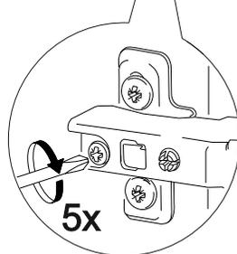
**РЕГУЛИРОВКА ДВЕРНЫХ ПЕТЕЛЬ:**
